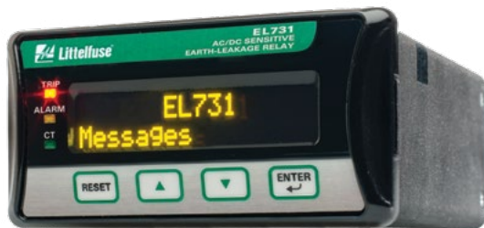
图4: EL731 是一款灵敏的交流-直流漏电继电器, 具有可编程报警和跳闸设置、继电器、模拟和串行输出以及 32 个字符的 OLED 显示屏。
