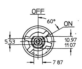
SWITCH SHOWN IN OFF POSITION & LEVER REMOVED
